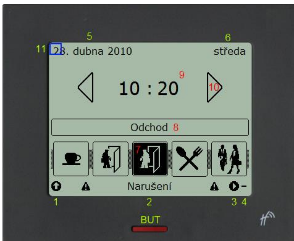
Obr 4: Ovládací prvky terminálu NDEM 31
