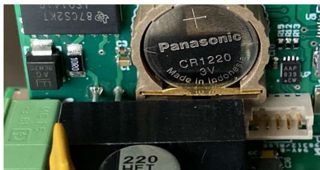
Obr. 4: Umístění držáku na RTC baterii
