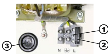
obr.2: Detail svorkovnice, pojistky a otvoru pro kabely
